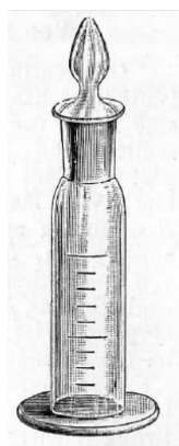
Cylinder szklany zaprojektowany przez Edmunda F. Biernackiego do pomiaru szybkości opadania krwinek czerwonych (wg.: Biernacki E.: Die spontane Blutsedimentierung als eine wissenschaftliche und praktisch-klinische Untersuchungsmethode. Dtsch. Med. Wschr. 1897; 48: 769-772)
